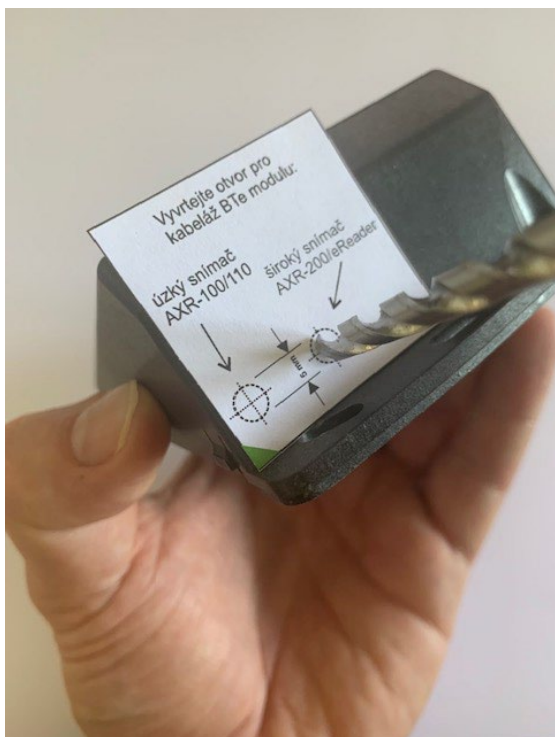
Obr. Vrtání otvoru pro široký kryt (ER, AXR-2xx)
